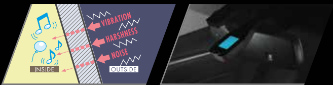
กระจกบังลมหน้าแบบกันเสียงรบกวน (Acoustic Glass) ช่วยลดเสียงรบกวนจากภายนอกอย่างมีประสิทธิภาพ
