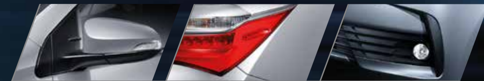
ครีบริมแหวกม่านอากาศที่กระจกมองข้าง ครีบริมแหวกม่านอากาศที่ไฟท้าย Rectifies Airflow บริเวณมุมกันชนด้านหน้า
