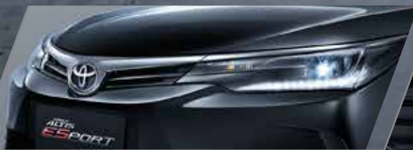
กระจังหน้าโครเมียม พร้อมแถบ Gun Metallic และไฟหน้า Bi-Beam LED Projector ปรับระดับอัตโนมัติ พร้อมแถบ Gun Metallic
