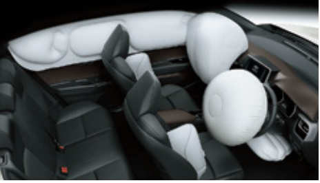
ถุงลมนิรภัย 7 ตำแหน่ง ปกป้องผู้ขับขี่และผู้โดยสาร ด้วยถุงลมนิรภัยคู่หน้า ด้านข้าง ด้านหน้าข้าง และหัวเข่าด้านคนขับ
