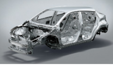
โครงสร้างตัวถังนิรภัย GOA พร้อมคานนิรภัย ช่วยดูดซับแรงกระแทกได้อย่างดีเยี่ยม รวมทั้งคานนิรภัยที่ประตูทั้ง 4 ด้าน
